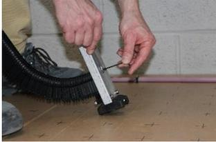
1. Les paquets d'agrafe doivent être positionnés sur la barre de guidage pointes vers le bas.
