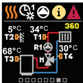
Schéma hydraulique avec l'écran montrant les températures mesurées
