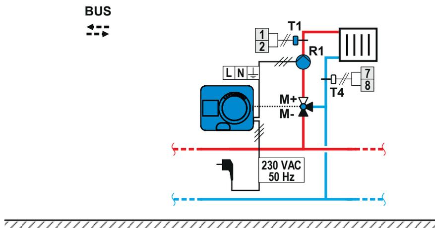
SCHÉMA 361 - circuit de chauffage
