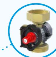
Vanne de mélange 3V robuste de haute qualité avec valeur Kvs réglable (2,5 à 12) pour une flexibilité maximale sur le chantier. Pour des installations jusqu'à 38 kW.
