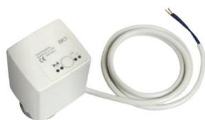
Moteur SK : A placer sur corps thermostatizable M30x1.5, connecté et alimenté par fil bus, il permet une régulation proportionnelle de l'émetteur.
