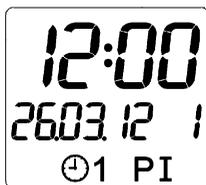
Figure 3 : Exemple affichage principal : 12:00 heure, 26.03.2012, Lundi, Mode "PROG. : ⌚", Secteur 1 actif, "Intervalle de fonctionnement automatique" et "Post-circulation pompe" actifs.
