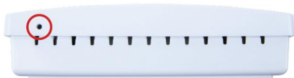
Figure 6 : Bouton de couplage dans les capteurs de température TS. Après un processus d'enregistrement correctement terminé, un message approprié apparaîtra sur l'affichage de l'unité WB02 F-8.
