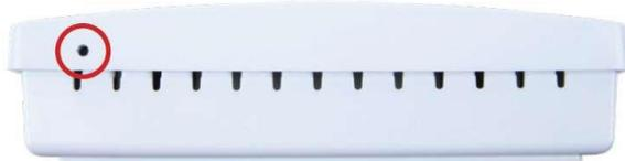
Figure 17 : Bouton de couplage dans les capteurs de température TS.
