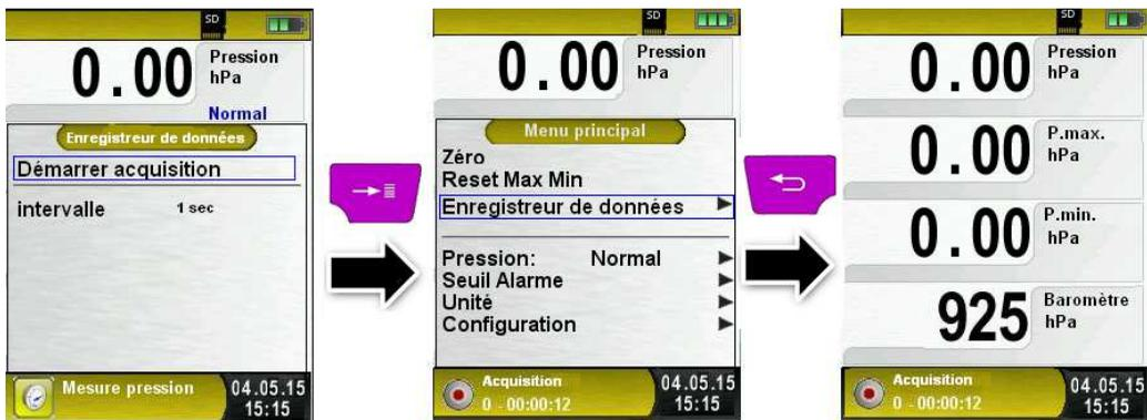
Le temps écoulé pendant la phase d'acquisition est indiqué dans la ligne information.
