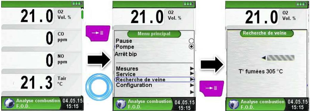
L'endroit idéal pour effectuer un contrôle de combustion est le centre de la veine des fumées, c'est l'endroit où les fumées sont les plus chaudes. Le moindre changement de température est affiché à l'écran sous forme d'une barre grise.
