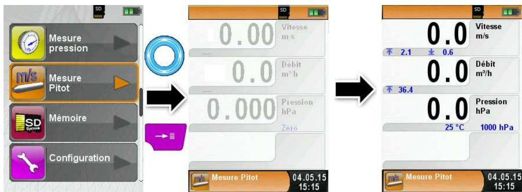
► **Configurer les données de la mesure (unités, facteur K du tube Pitot, la forme et les dimensions du conduit).**
