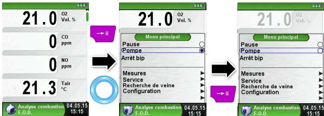
Lorsque la pompe est arrêtée, les valeurs de la combustion sont indiquées en gris. Les mesures affichées peuvent toutefois continuer à évoluer. En cas d'arrêt prolongé de la pompe, un nouvel étalonnage avec de l'air ambiant est préconisé avant de reprendre les mesures.
