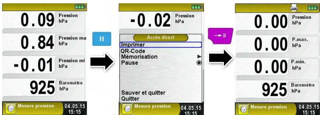
L'Eurolyzer® STx est multitâche, l'impression débute dès la validation. Les mesures en arrière-plan continuent d'être mises à jour.
