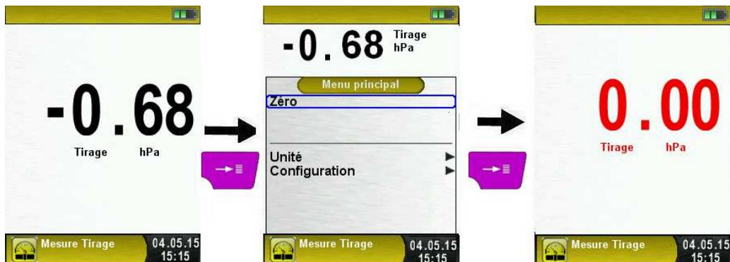
Pour réaliser la mise à zéro du capteur de tirage, il est nécessaire au préalable de débrancher le tuyau Tirage (raccord bleu) de l'appareil. La mise à zéro ("0.00 hPa") peut ensuite être effectuée.
