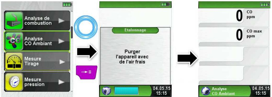
Si la valeur mesurée dépasse le premier seuil d'alarme (10 ppm), une alarme sonore se déclenche, en cas de dépassement du deuxième seuil d'alarme (50 ppm) le CO est affiché en rouge.
