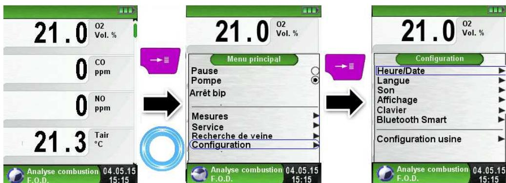
Schéma 12 : La fonction "Configuration" par le menu principal de la fonction "Analyse de combustion"
