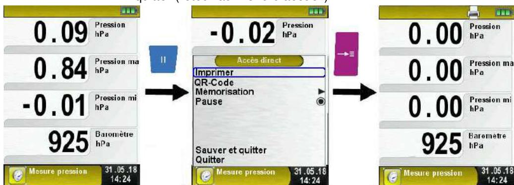
Le Multilyzer®STx est multitâche, l'impression débute dès la validation. Les mesures en arrière-plan continuent d'être mises à jour.
