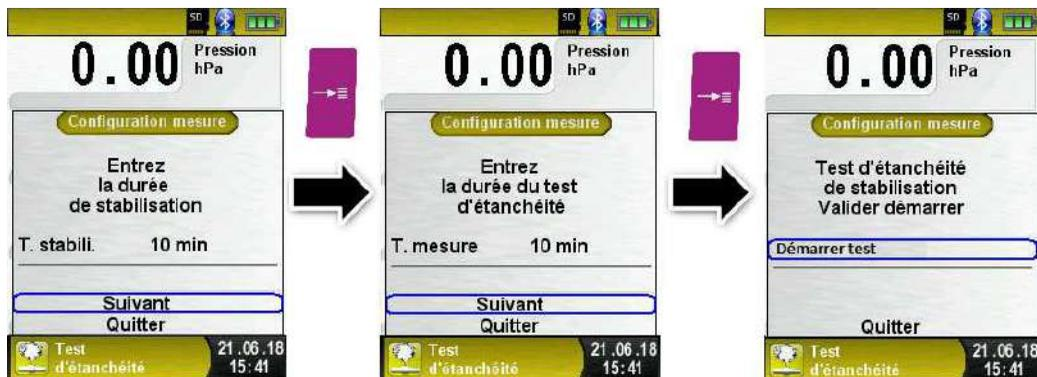
Lorsque le temps de stabilisation ainsi que la durée du test sont configurés, démarrer le test d'étanchéité.
