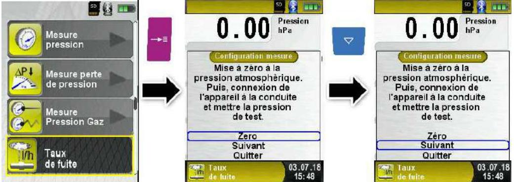
Il est possible d'insérer manuellement le volume de la conduite. Si le volume est inconnu, le calcul peut se faire automatiquement.
