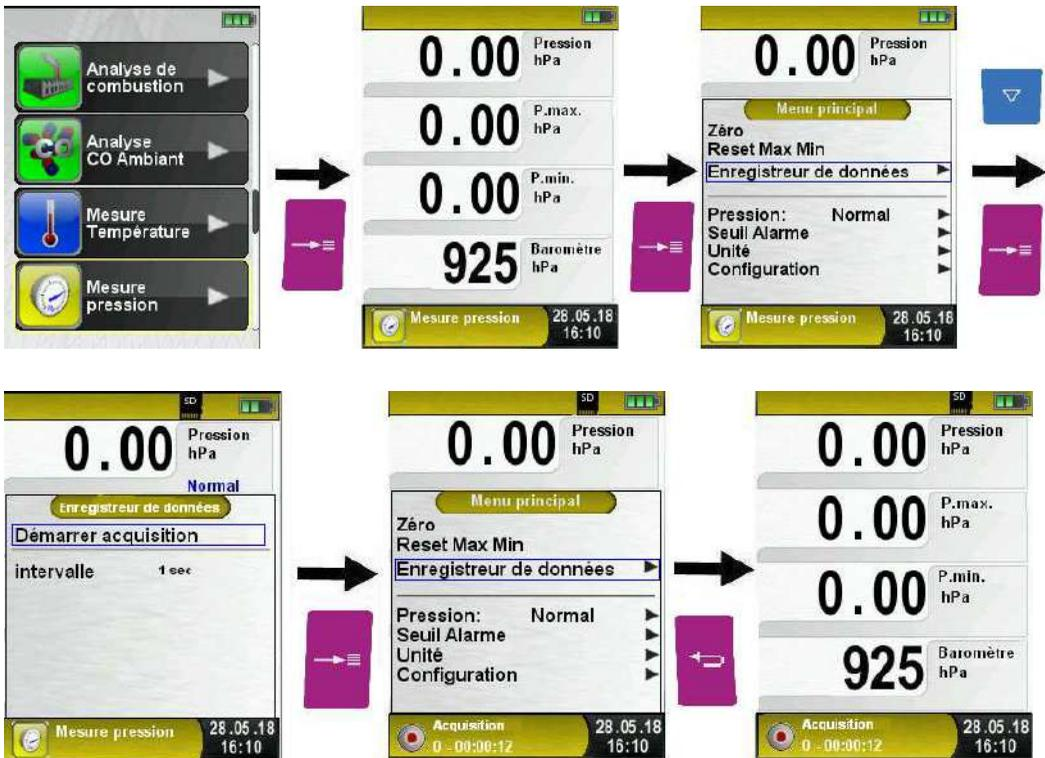
Le temps écoulé pendant la phase d'acquisition est indiqué dans la ligne information.
