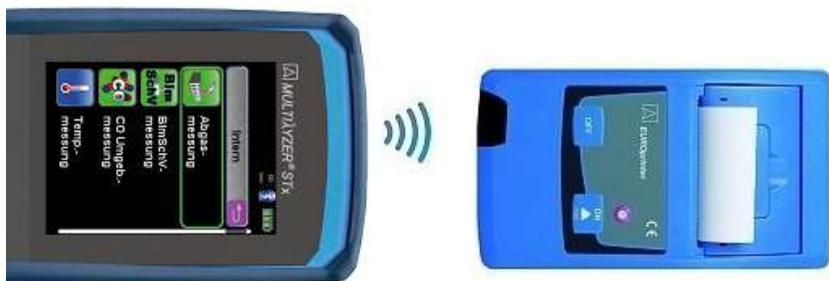
Schéma 3 : Alignement des appareils lors de l'impression
