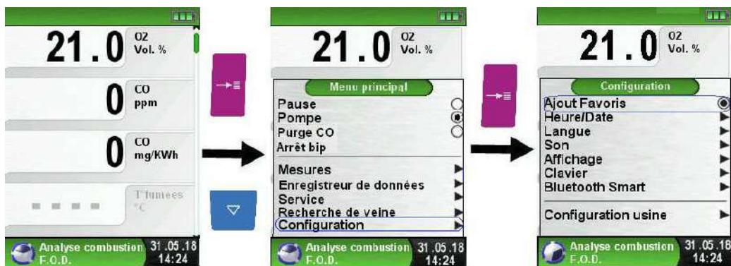
Schéma 11 : La fonction "Configuration" par le menu principal de la fonction "Analyse de combustion"
