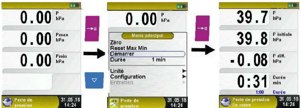
Lorsque le test se termine, la pression initiale et finale ainsi que la pression différentielle sont affichées.
